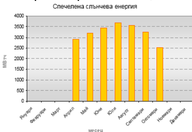
Фиг. 17: Разпределение на възможната за оползотворяване слънчева енергия по месеци при сезонна работа на инсталациите
